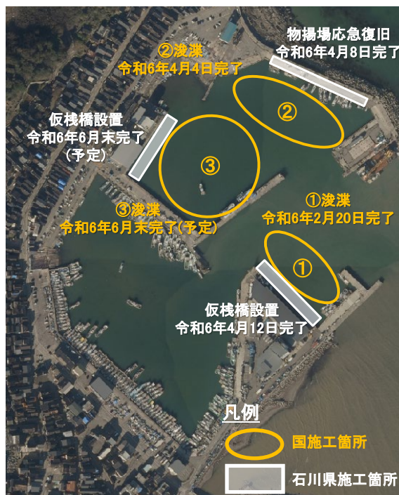
輪島港漁船だまり浚渫・仮棧橋設置等工程
