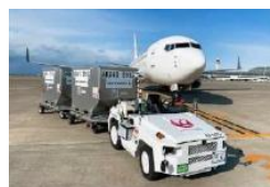
空港制限区域内の自動運転トローイングトラクター
