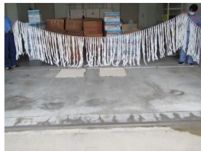
▲油吸着材 上：吹き流し型 下：マット型
