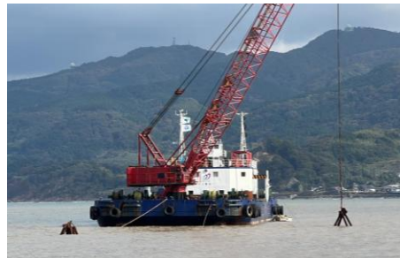
起重機船（弘武）による緊急浚渫状況
