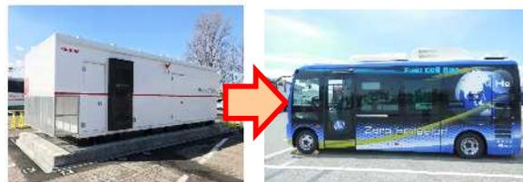
「H2One ST Unit™」は、再生可能エネルギーで発電した電力により水素を製造し、FCVIに充填できるシステムです。日中の稼働でFCVが約8台運用可能な水素製造能力を有し、最速3分で満充填が可能です。本システムはコンテナ1台で構成され、補機等の別ユニットが無いため、電気や給排水工事のみで設備導入ができ、工場、港湾、空港やバスの営業所などさまざまな用途に対応します。今回は隣接地に太陽光発電パネル(出力約20kW)を設置し、再生可能エネルギーを利用して水素を製造します。
