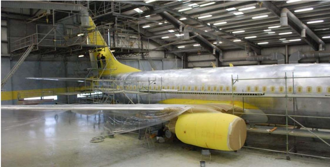
写真＝立地企業のひとつ、航空機再塗装業者 MAAS Aviation。ボーイング 737 の再塗装中
