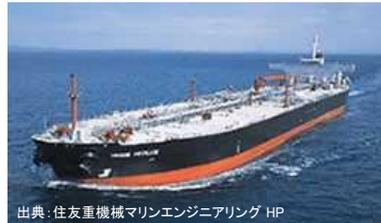
(注3)<br>10万トン級プロダクトタンカー                                                                     | プロダクトタンカー<br>8万～16万DWT<br>(10万DWTの場合)<br>喫水 <b>14.9m</b><br>
