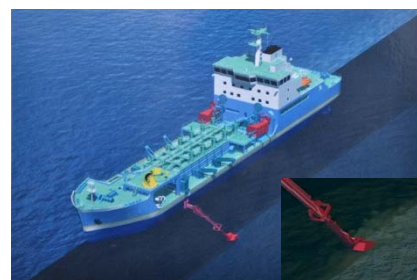
③ 白山は船舶航行の安全を確保するため24時間体制で、堆積した土砂を浚渫しています。
