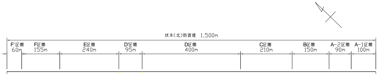
図 1.1.4 北防波堤の設計区間の区割り (平面図)
