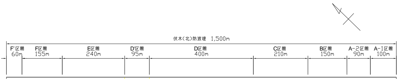
図 3.4.1 北防波堤の設計区間の区割り (平面図)
