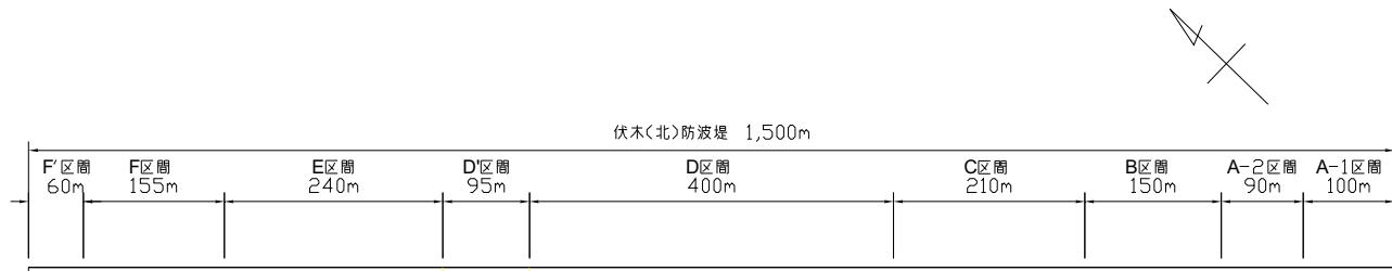
図 1.2-1 北防波堤の設計区間の区割り (平面図)
