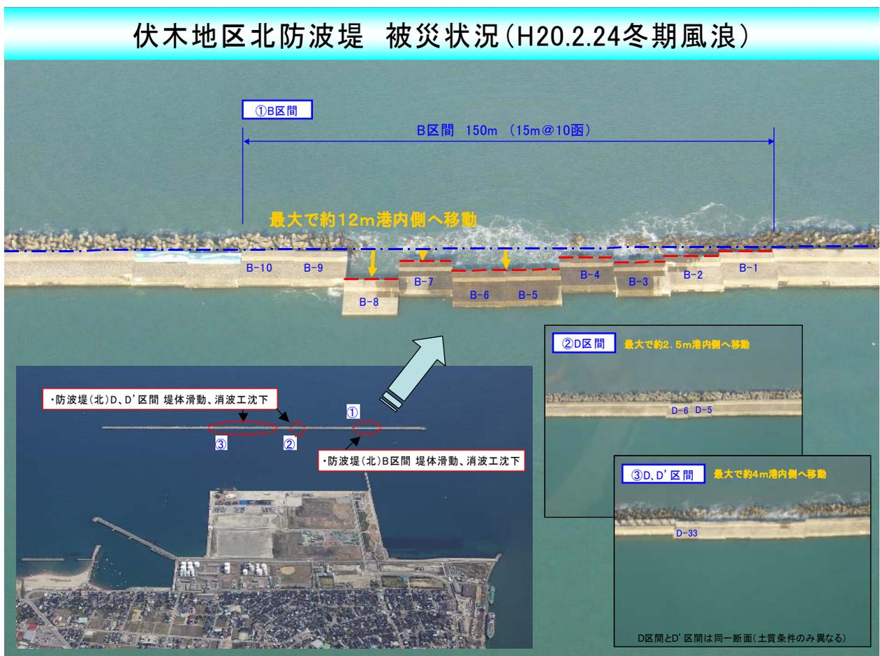
図 1.1.4 北防波堤の被災状況
