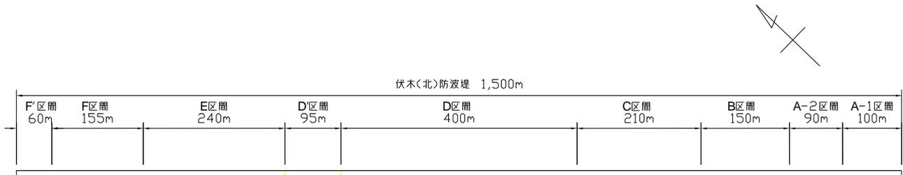
図 1.1.3 北防波堤の設計区間の区割り (平面図)
