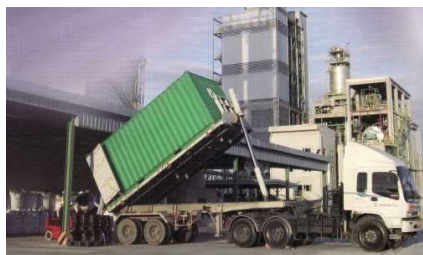
バルクコンテナのダンプアップによる払出
