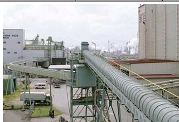
ベルトコンベアでの保管施設内輸送
