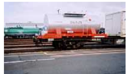
エンジン付きコンプレッサー圧送式タンクコンテナ
