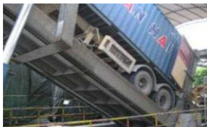
バルクコンテナのチルトアップによる払出
